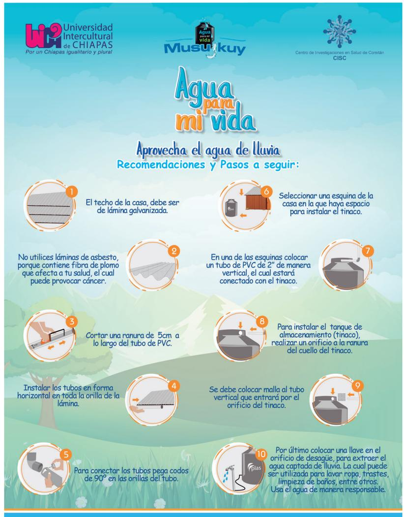
Cartel. Manual construcción sistema de captación de agua pluvial. FUENTE: ELABORACIÓN PROPIA
